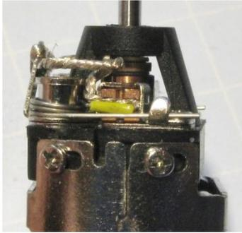
Die Federn sind unsymmetrisch und werden so angebracht, dass die Federarme parallel liegen. Als letzten Schritt nehme ich feine Litze, führe sie in den Kohleschlitz, klemme die Feder darauf und forme einen Bogen. Die Lötflanke wird umwickelt, dann kann die Litze endgültig ausgeformt werden. Wichtig ist, dass die Litze auch noch nach dem Anlöten flexibel ist. Die Haken, die den langen Federarm halten, werden so gerichtet, dass sich die Feder nur mit Druck aushebeln lässt.
