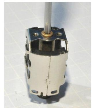
Reibt man das Loch passend auf, ist das Einlöten einfach, ist es größer als das Kugellager, muss man das Lager beim Einlöten zentrieren. Dazu hat man einen Kern oder als Notlösung umwickelt man den Anker mit Papier, bis er straff zwischen die Magnete passt.
