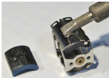
Vorsicht! Das Gehäuse verbiegt schnell und die Magnete sind spröde, dadurch platzt schnell Material ab. Sind die Magnete gelöst, werden sie und das Gehäuse vom Kleber gereinigt. Dafür benutze ich Messer, Schlüsselfeile und Sandpapier.
