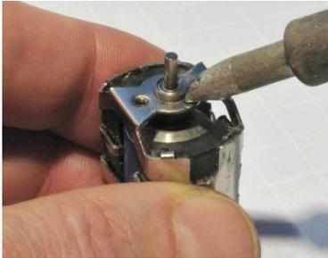
aufgeraut. Das Lager wird so auf die Achse gesteckt, dass zwei Drittel aus dem Gehäuse heraus stehen. Dadurch nimmt man die Kräfte vom Getriebe so dicht am Ritzel wie möglich auf.
