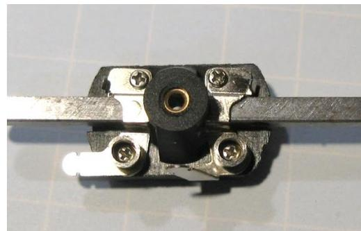
Ohne Hilfsmittel muss man eben mit Augenmaß arbeiten. Dann nimmt man die Kohlen nach dem Einlaufen noch einmal heraus und prüft, wie die Kohlen am Kollektor anliegen und stellt die Beschläge gegebenenfalls nach.
