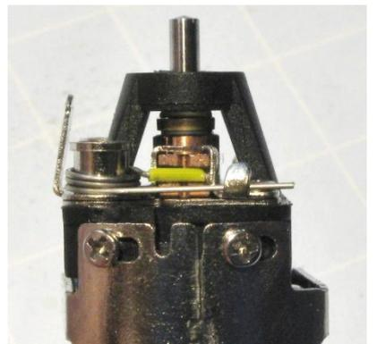
An den Kohlen werden die Schlitzte vergrößert, damit Shunts und isolierte Federn Platz haben. Jetzt kann man die Kohlen einstecken und die Federn anklemmen.
