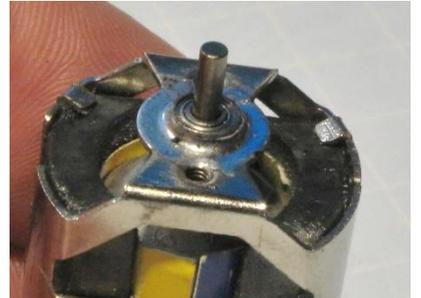
Lötwasser bestrichen. Vorsichtig, damit kein Lötwasser ins Lager kommt. Jetzt wird etwas Zinn auf die Kolbenspitze gegeben um das Lager gezogen. Ist der LötKolben heiß und das Lötwasser aggressiv genug, verläuft das Zinn gleichmäßig.
