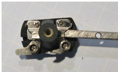
Beim Blick auf die Beschläge stellt man fest, dass sie nicht sorgfältig ausgerichtet wurden. In diesem abgebildeten Beispiel sieht sogar extremes Schrägstehen des Beschlages. Mit einem Kohleführungsstab (Brush hood alignment tool) ist das Richten der Beschläge einfach.
