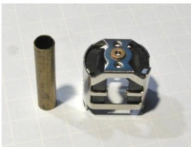
Für den Einbau eines Kugellagers im Gehäuse muss das eingepresste Gleitlager entfernt werden. Ich habe zum Abstützen des Gehäuses ein kurzes Rohr, welches über das Gleitlager (Außendurchmesser 6,2 mm) passt und drücke das Lager mit einem leichten Schlag heraus.
